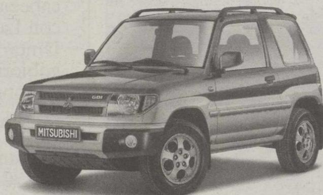
GDI (inyección directa de gasolina) de 1,8 litros, 120 cv. Equipamiento: Transmisión Super Select 4WD SS4-i, dirección asistida, airbag SRS, display multifunción, cierre centralizado, elevalunas eléctricos.
