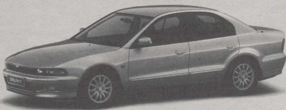
Motores: 2.0 de 16 válvulas y 136 CV ó 2.5 con 6 cilindros en V, 24 válvulas y 163 CV. Equipamiento de serie: ABS, doble airbag SRS, barras de protección en puertas, suspensión Multi-link, inmovilizador electrónico y climatizador. 3 años de garantía sin límite de kilometraje. Asistencia en viaje 24 h. en toda Europa.
