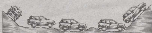
Inclinación lateral máxima 48°. Puede pasar sobre obstáculos de 210 mm. de altura. Profundidad de vadeo: 450 mm. Ángulo de aproximación: 35°. Pendiente máxima superable 39°.
