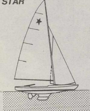
Es el barco técnico por excelencia. Sus características le hacen ser una embarcación muy rápida y de difícil manejo. La tripulación se compone de dos miembros. El Star fue creado en 1906. Su eslora es de 6,92 metros, la manga de 1,73, lo que le hace ser un barco especialmente aerodinámico.
