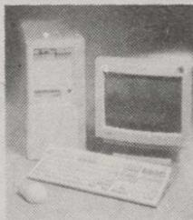
Procesador: 80286 - 20 Mhz Memoria RAM: 1 Mb Floppys: 3 1/2" 1,44 Mb Disco Duro: 42 Mb (23 Ms) Monitor: VGA Monocromo Teclado: 102 Teclas
