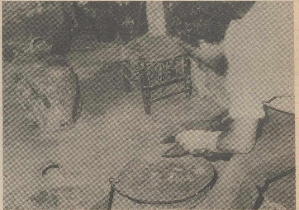
Con las tijeras se recorta la chapa que más tarde será un cencerro.
