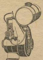
motor refrigerado por aire de 1, 2 y 4 c.v.
