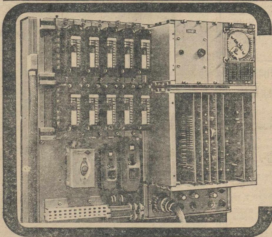
Los equipos de mando y control están contruidos dentro de la más avanzada tecnología electrónica a nivel europeo. La total transistorización del equipo y los circuitos impresos de simplificado diseño garantizan un servicio continuado en las condiciones climáticas más rigurosas.
