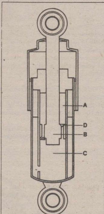
Amortiguador hidráulico telescópico
