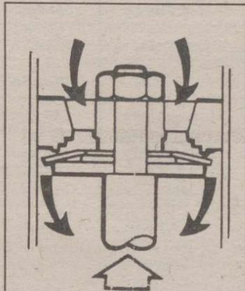
La disposición de la válvula en el pistón de trabajo dificulta más el paso del fluido cuando el pistón se mueve hacia arriba.
