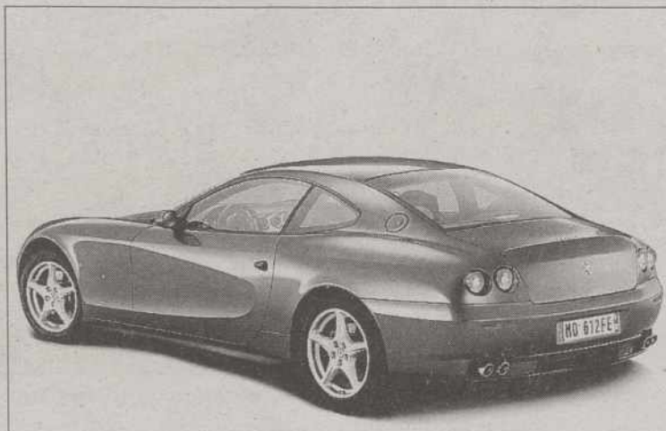
La profusión de elementos en aluminio otorga una mayor rigidez y menor peso.
