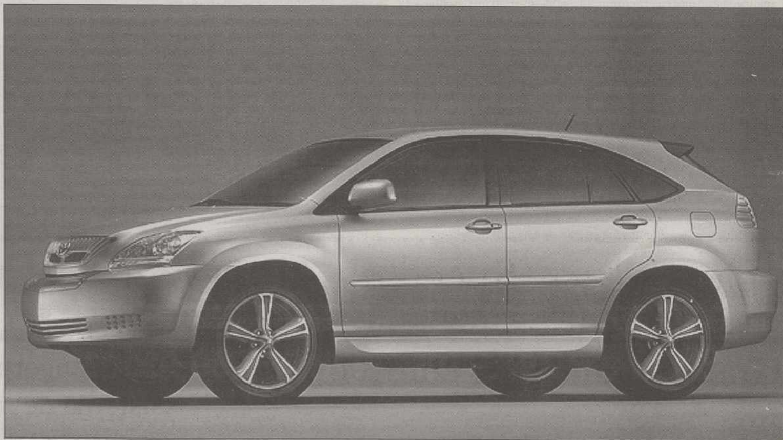
El SU-HV1 es un todoterreno o todoterreno ligero híbrido con motor de gasolina V6 de 3.3 litros y eléctrico de 120 kW.
