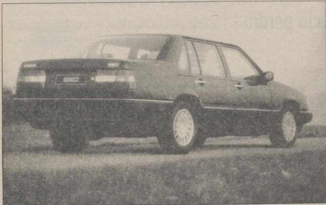
El Volvo 960 (el nuevo modelo de prestigio) presenta un nuevo y elegante diseño y una mecánica completamente nueva, con un motor de 6 cilindros en línea y 3 litros de cilindrada y una caja de cambios automática, controlada electrónicamente. El nuevo motor, B6304F, tiene doble árbol de levas en culata, 24 válvulas y una potencia de 150 kw (204 CV), que combina el confort y las prestaciones con conceptos de conservación de la energía y respeto por el medio ambiente.
