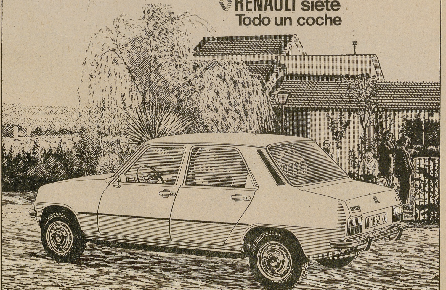
Motor Renault 1.037 cm 3 Tracción delantera. Suspensión por barras de torsión. Cuatro puertas.
