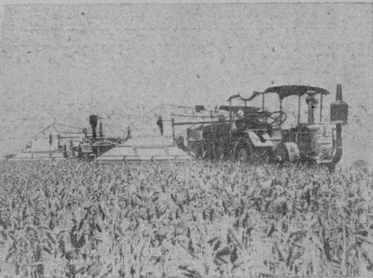
Máquinas empleadas en Vitoria (Australia) para la recolección de una de las mayores cosechas de trigo que se recuerda. El trigo pasa directamente de las descabezadoras representadas a camiones especiales que llevan el cereal a los silos, sin ensacar.
