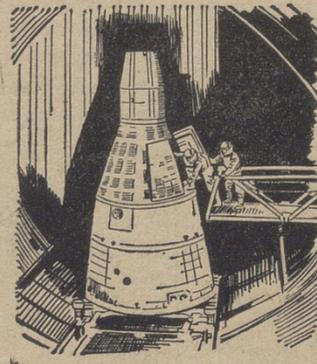
El entrenamiento para los vuelos espaciales se hace por medio de numerosas máquinas que simulan las condiciones del espacio, simulando con todo detalle el vuelo del vehículo. A través de la ventana del aparato el astronauta puede ver la Luna, las estrellas y el horizonte curvo de la Tierra, tan bien reproducidos que puede practicar la navegación por medio de las estrellas.
