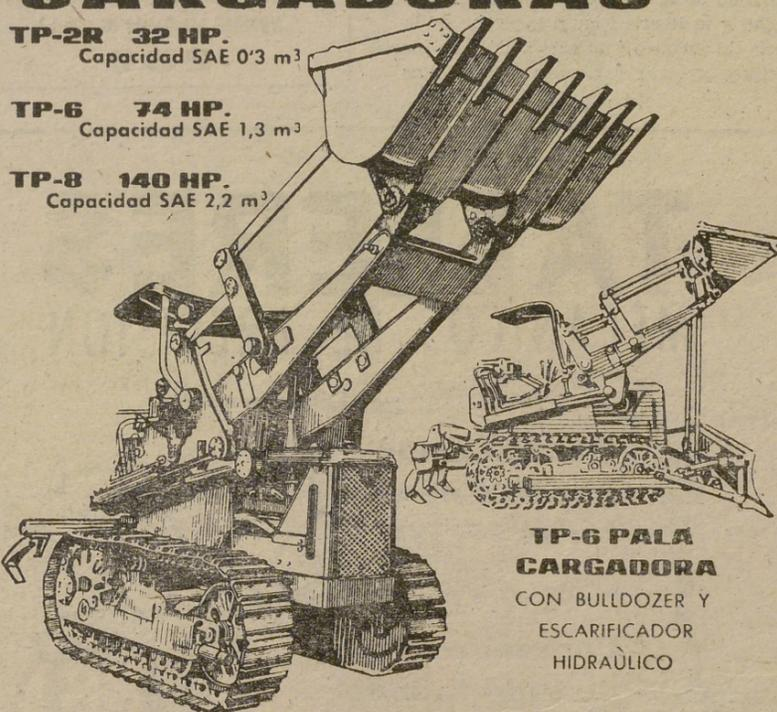
**TP-6 PALA CARGADORA CON BULLDOZER Y ESCARIFICADOR HIDRAÚLICO**
