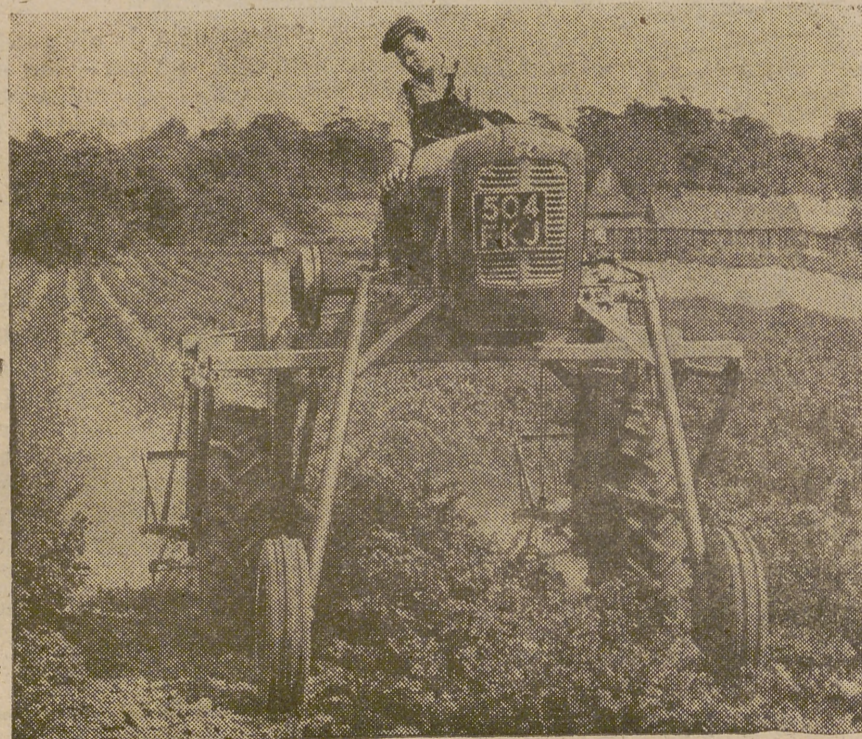
El nuevo tractor «Lenfield Flamingo» substituye a la grada tirada por caballo en un cultivo de grosella, en Kent, realizando en medio día el trabajo de una semana. Este «tractor sobre zancos» es una máquina Massey-Harris-Ferguson 35 de tipo ordinario, dotado de un mecanismo especial de conversión que le permite elevarse a 1,37 m. sobre el terreno. Todas las palancas de control y de conducción se mantienen en posición destrabada, y la adaptación puede ser realizada por el granjero mismo con ayuda de un malacate. Las huellas son de 5, 6 y 7 ples (1,37, 1,83 y 2,13 metros).
