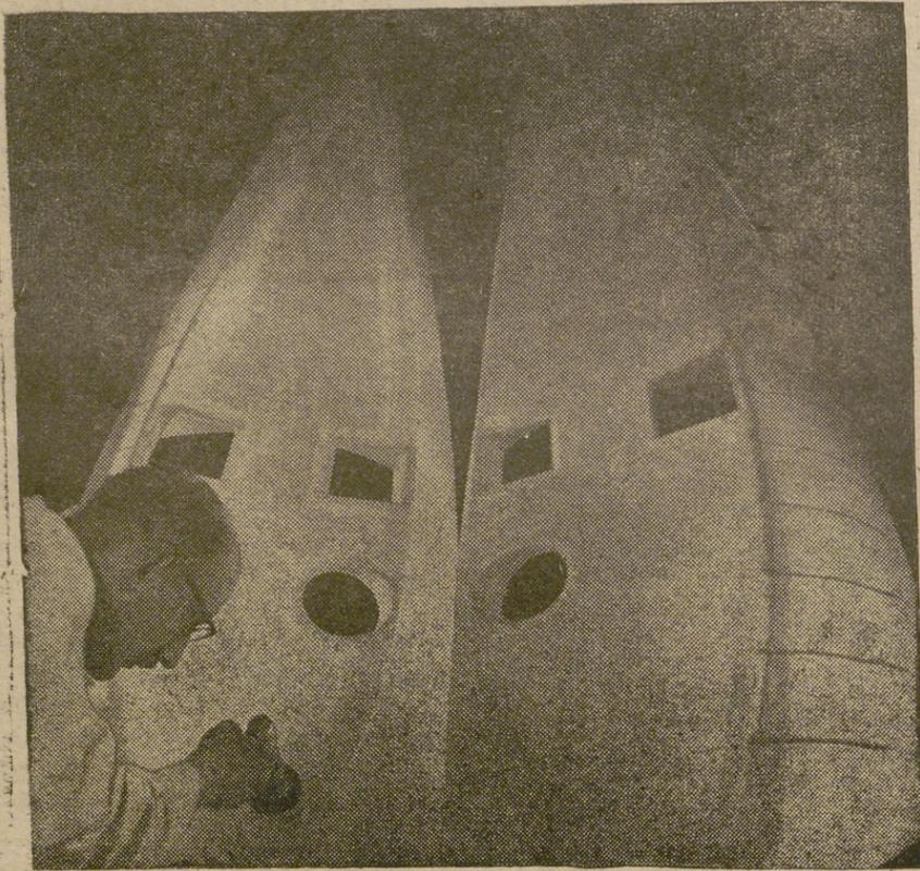
Esta curiosa fotografía muestra a un obrero dando los toques finales a un par de fuselados para tanques desprendibles de combustible que se montan en los extremos de las alas de los aviones. El comportamiento aerodinámico de los tanques de plástico moldeado es considerablemente mejor que el de los tanques metálicos similares. Poseen la misma resistencia y peso, pero son más fáciles y baratos de fabricar y tienen ventajas especiales en cuanto al almacenamiento y manipulación.
