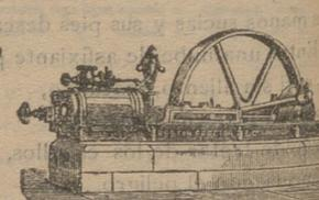
Máquina de vapor fija horizontal
