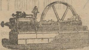
Máquina de vapor fija horizontal
