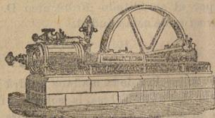
Máquina de vapor fija horizontal
