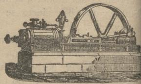
Máquina de vapor fija horizontal.
