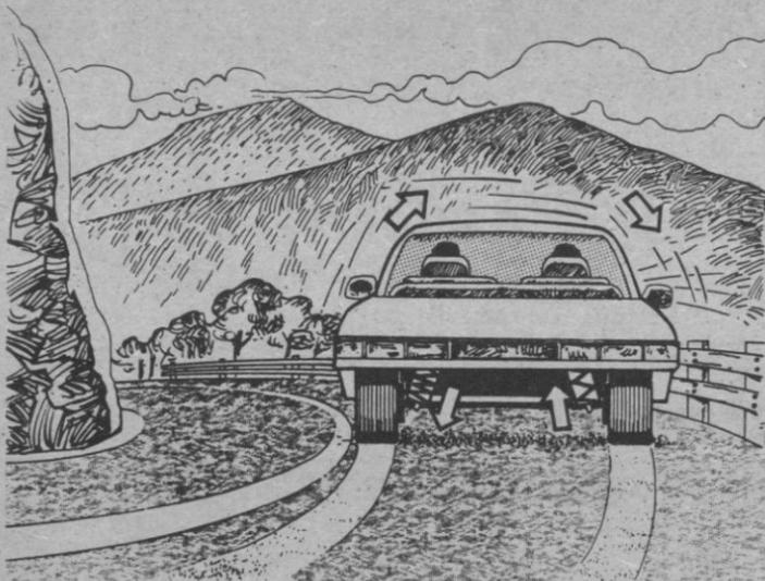
Para contrarrestar estas alteraciones y controlarlas, están los sistemas de suspensión. Y para mejor comprender la misión y funcionamiento de este complejo mecanismo que actúa entre las carrocerías y las ruedas, podríamos utilizar el ejemplo de la concha de un enorme crustáceo. La carrocería de un automóvil, al igual que la concha, alberga y protege a los pasajeros y los sistemas de suspensión, son los miembros que la mantienen en contacto con el suelo.
