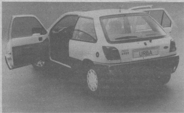
Ford ha diseñado y desarrollado un nuevo coche experimental para ciudad, a partir de su nuevo Fiesta, con una sola puerta para el conductor, dos para los pasajeros de detrás y un filtro contra los gases de la circulación instalado en el sistema de la calefacción y ventilación.
