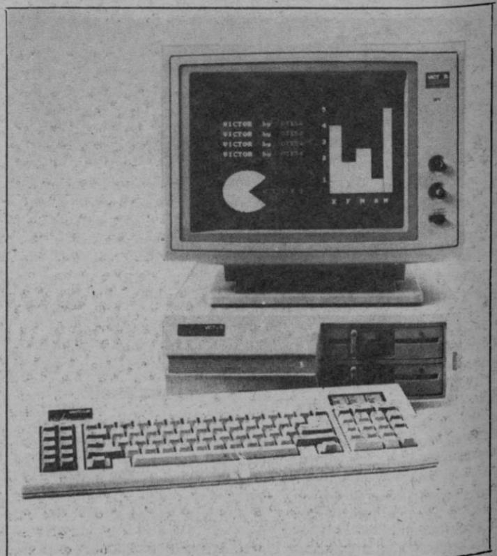
Vicki PC de Victor con microprocesador Intel 8088/2, velocidad de 4,77-8 Mhz., 512 Kb de RAM ampliable a 640, monitor monocromo de 14 pulgadas y sistema operativo NS-DOS 3.2. (Foto EFE)
