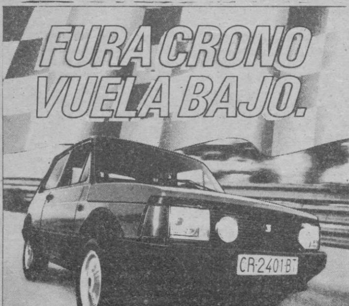
1.438 cc. / 75 CV DIN / Vel. máx. 160 km/h. / Aceleración 0-100 km/h. en 10,8 segs. / Carburador de doble cuerpo / Quinta marcha / Encendido electrónico / Embrague y suspensión reforzados / Servofreno / Para golpes absorbente / Faros anti-
