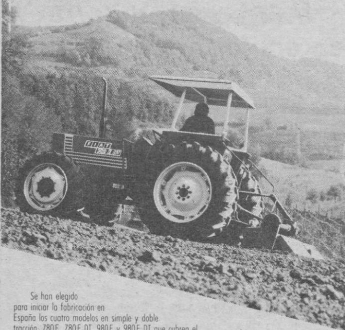
Se han elegido para iniciar la fabricación en España los cuatro modelos en simple y doble tracción: 780E, 780E DT, 980E y 980E DT que cubren el importante sector de la demanda comprendido entre los 80 y 100 CV.
