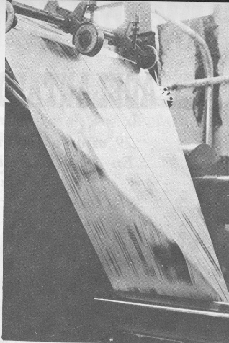
Concluidas las fases de montaje en astralones y por grupos de cuatro planas, se pasan a la insoladora para imprimirlas en las planchas que seguidamente se colocan en la rotativa... Minutos después, el periódico, «en caliente», sale a gran velocidad camino de la plegadora, desde la que se iniciará la distribución.
