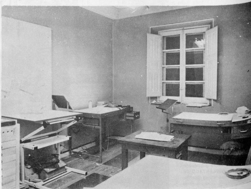
*El siguiente proceso se verifica en la sala de montaje, sobre mesas translúcidas, en las que se van montando los textos sobre hojas, conforme las maquetas que se proporcionan.*
