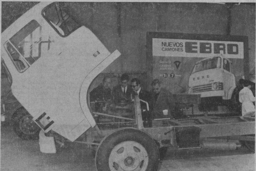
Fácil y rápidamente abatible la cabina del nuevo EBRO serie D, deja totalmente al descubierto su motor lo que permite un cómodo entretenimiento con evidente ahorro de tiempo y dinero.
