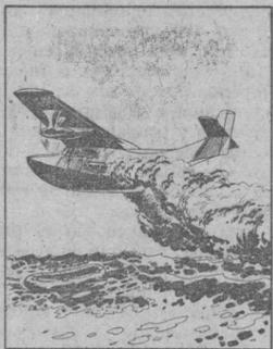
**JATO.**—Otra aplicación espectacular y utilísima de la fuerza de empuje de los cohetes es el sistema JATO, o despegue con motores coheticos auxiliares. Este dispositivo de despegue consta de pequeños motores coheticos adheridos a los aviones de carga para permitirles despegar en pista de longitud inferior a lo normal. La JATO es especialmente útil en casos de emergencia en lugares desprovistos de instalaciones convencionales de aterrizaje.
