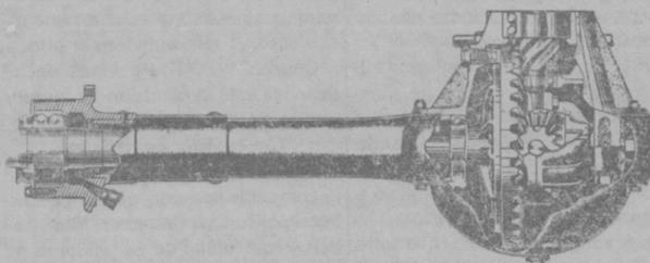
Robustos paliers, piñón a horcajadas, cojinete de palier de doble hilera... El eje trasero del Chevrolet tiene una resistencia muy superior a la que pueda necesitar a diario.
