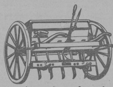
Sembradoras con y sin d stribuidores, con rejas fijas y flexibles, en varios sistemas y tipos.
