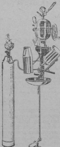
Máquina para la fabricación de gaseosas, sifones y toda clase de aguas carbónicas.
