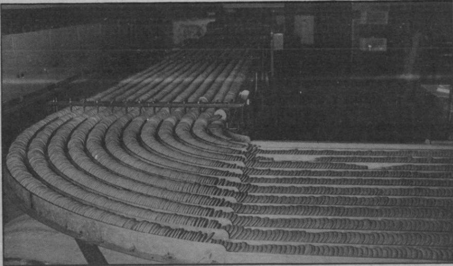
El proceso de elaboración de galletas no es excesivamente complicado. La pasta es recortada por una máquina, que ya da la forma a las galletas, y luego los moldes pasan por el proceso de cocción
