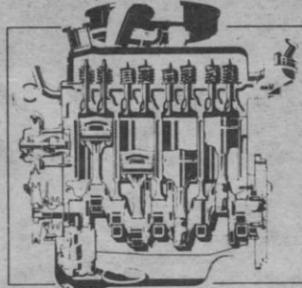
Motor de 1438 cc. y 77 CV DIN
