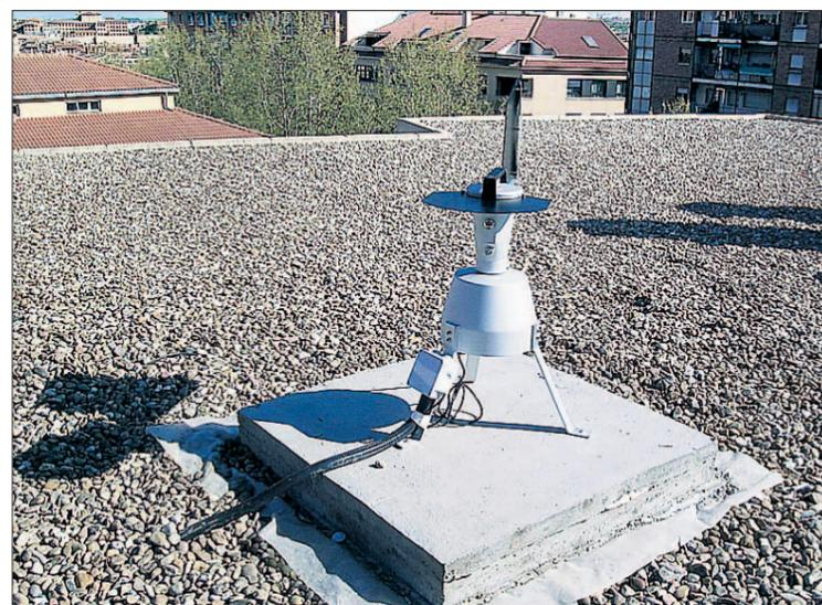
Estación de medición con captadores de polen. / E. A.
