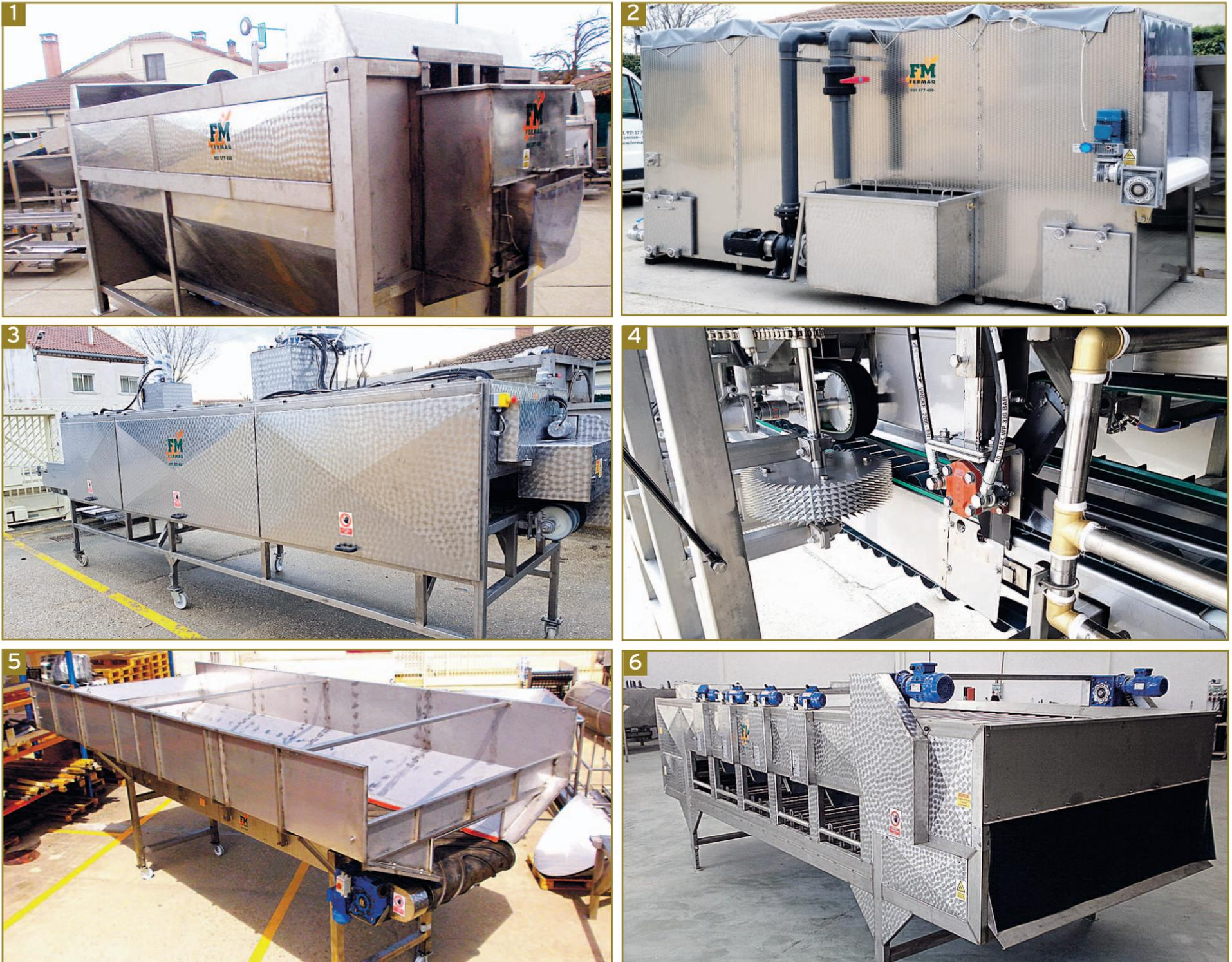
1. Lavadora de hortalizas. 2. Hidrocooler. 3&4. Limpiadora, peladora y cortador de puerro. 5. Tolva de recepción. 6. Calibradora diametral. / FOTOS FERMAQ.
