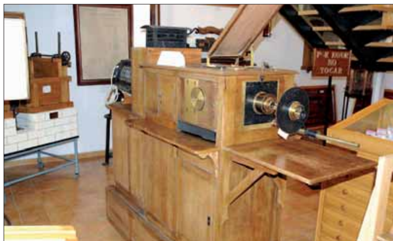
Epidiáscopo Universal. Proyección de cuerpos opacos transparentes.
