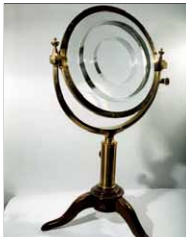
Lente de Fresnel. Destinada a hacer paralelos los rayos de un solo foco.
