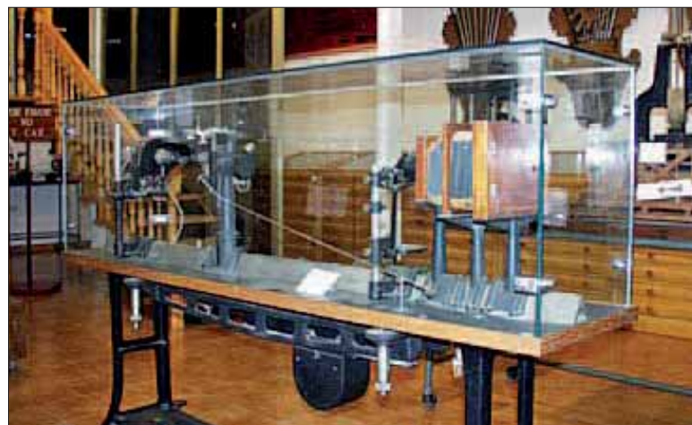
Microscopio metalográfico. Para el estudio de la composición física de los metales.
