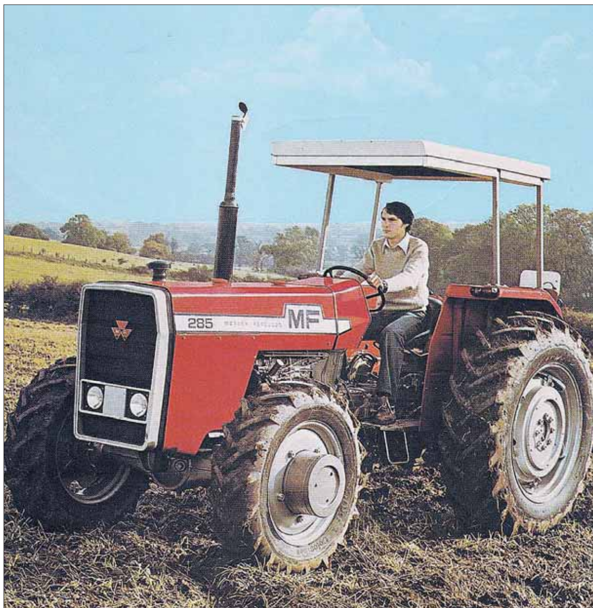
En 1977, el motor de 69 caballos del MF-285 supuso una gran novedad dentro de la maquinaria agrícola. / EL ADELANTADO
