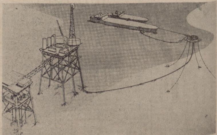
Esquema de la futura explotación del yacimiento: torres de extracción, tubo conductor, boya y barcaza-depósito.
