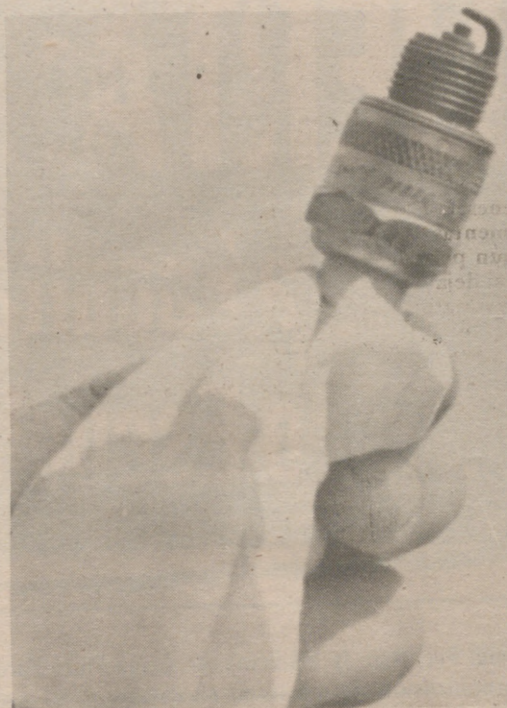
Observando el color de los electrodos de una bujía se puede averiguar el estado del motor.
