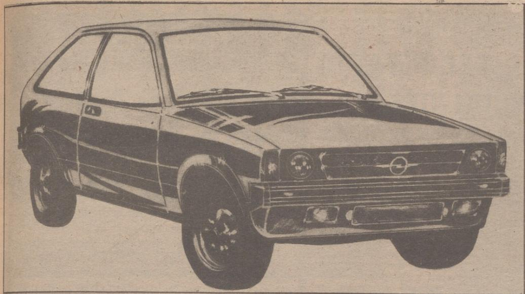
Este es el modelo de la General Motors que saldrá de la factoría de Figueruelas, según un grabado de "Auto-revista". El coche ha sido diseñado por Opel y se trata de un prototipo pequeño, en la línea Fiesta, con cilindradas entre 900 y 1.300 c. c. tracción delantera, con frenos de disco en las ruedas anteriores, dirección de cremallera, portón trasero y dos puertas laterales
