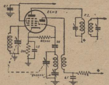
Fig. 133.—Circuito mezclador con lámpara Triodo-hexodo
