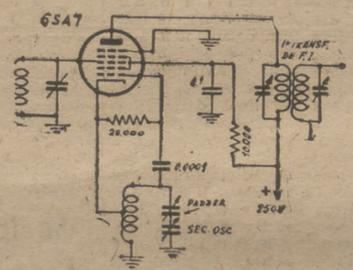
Fig. 134.—Circuito mezclador con oscilador de acoplamiento electrónico
