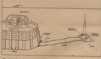
Registrador de mareas en los puertos por ondas supersónicas. Ambos osciladores se colocan en el fondo del océano, y las ondas que atraviesan el agua son reflejadas hacia abajo desde la superficie. El equipo mide el tiempo que se necesita para que la onda viaje desde el fondo a la superficie y de la superficie al fondo; convierte estos datos en medidas del nivel de la marea y registra el resultado sobre unas cintas de papel
