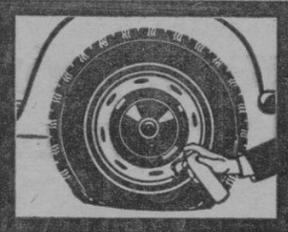
1 Atornille el raccord del aerosol a la válvula del neumático y deje salir la espuma de goma contenida en FINILEC.
