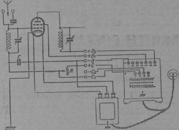
Fig. 3. — Conexión de un aparato de tensión de anodo tipo 3003
