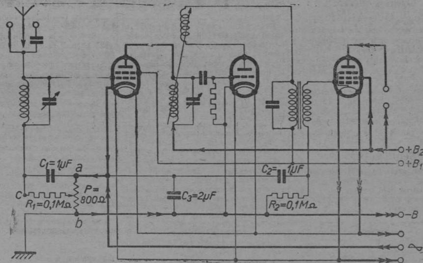
Fig. 4.—Esquema de un receptor sin pila de polarización exterior
