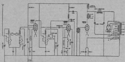
Circuito típico de 3 válvulas para corriente alterna con las nuevas valvulas metálicas "KATKIN" Geco, que representa Empresas Radio Eléctricas, Peligros, 2.
