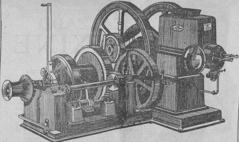
Fabricado para el trabajo rudo en los Trasmordadores de Caña. MOTOR LAUSON de petróleo refinado. Engranajes fresados a máquina. Montado sobre base de hierro. Dos tamaños, 6 y 8 caballos de fuerza.
