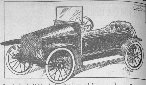
Con alumbrado eléctrico, bocina eléctrica, guardafangos cerrados, amplio estribo freno de mano, parabrisas de cristal y cojines blandos, recubiertos de cuero. Gobierno, pedales, transmisión y todas las fricciones, montadas sobre cojinetes de acero. La transmisión es por cadenas,
