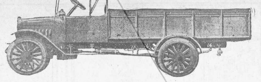
Chassis listo para aplicar la carrocería apropiada al trabajo a que se destinen. El Regulador del motor es automático y evita excesos de velocidad. Carburador provisto de entrada para aire caliente, lo que aumenta la economía de combustible y permite usar los inferiores.
