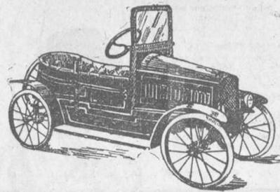
Trasmisión de catalina, con cojinetes de acero en los pedales y ruedas. Guardafangos. Parabrisa y freno de emergencias.
